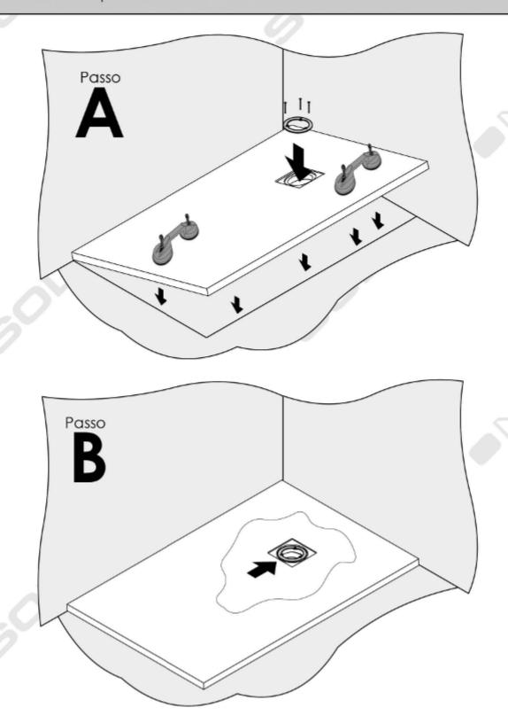
**Fissaggio del piatto**. Collocare perimetralmente la bandella impermeabilizzante negli angoli adiacenti alle pareti. Applicare, sopra la base di malta, delle strisce di adesivo sigillante elastico poliuretanico (Passo A). Appoggiare il piatto doccia sulla base avendo cura che la piletta sia perfettamente coassiale con il foro dello scarico e che il piatto sia livellato (Passo B).
